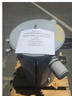
a). 37.5 kVA transformer
